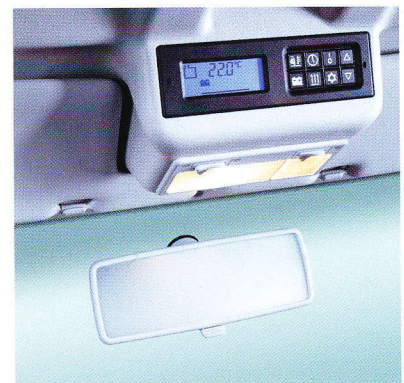
Im Blickfeld angeordnete Zentral-elektronik mit Bedienung für Standheizung und Kühlbox.
