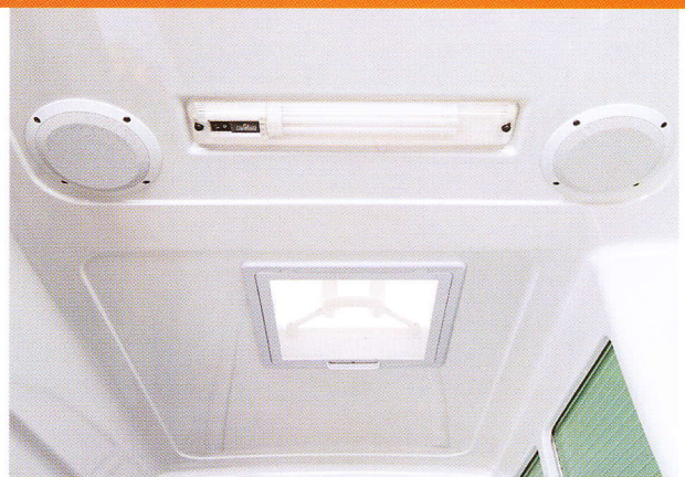
Aufstellbarer Dachlüfter mit Moskitonetz, serienmäßige Lautsprecher und Transistorlampe.
