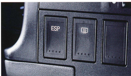
Tastenschalter zum Ein- und Ausschalten des ESP.
