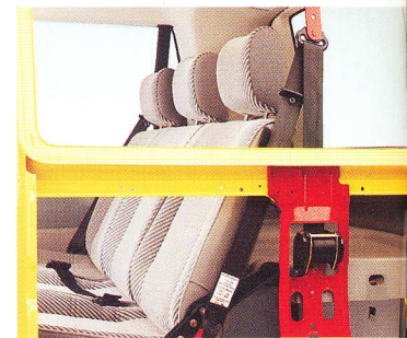
Verstärkung der Dachkonstruktion und der Sicherheitsgurtbefestigung, am Beispiel der Caravelle-Baureihe.
