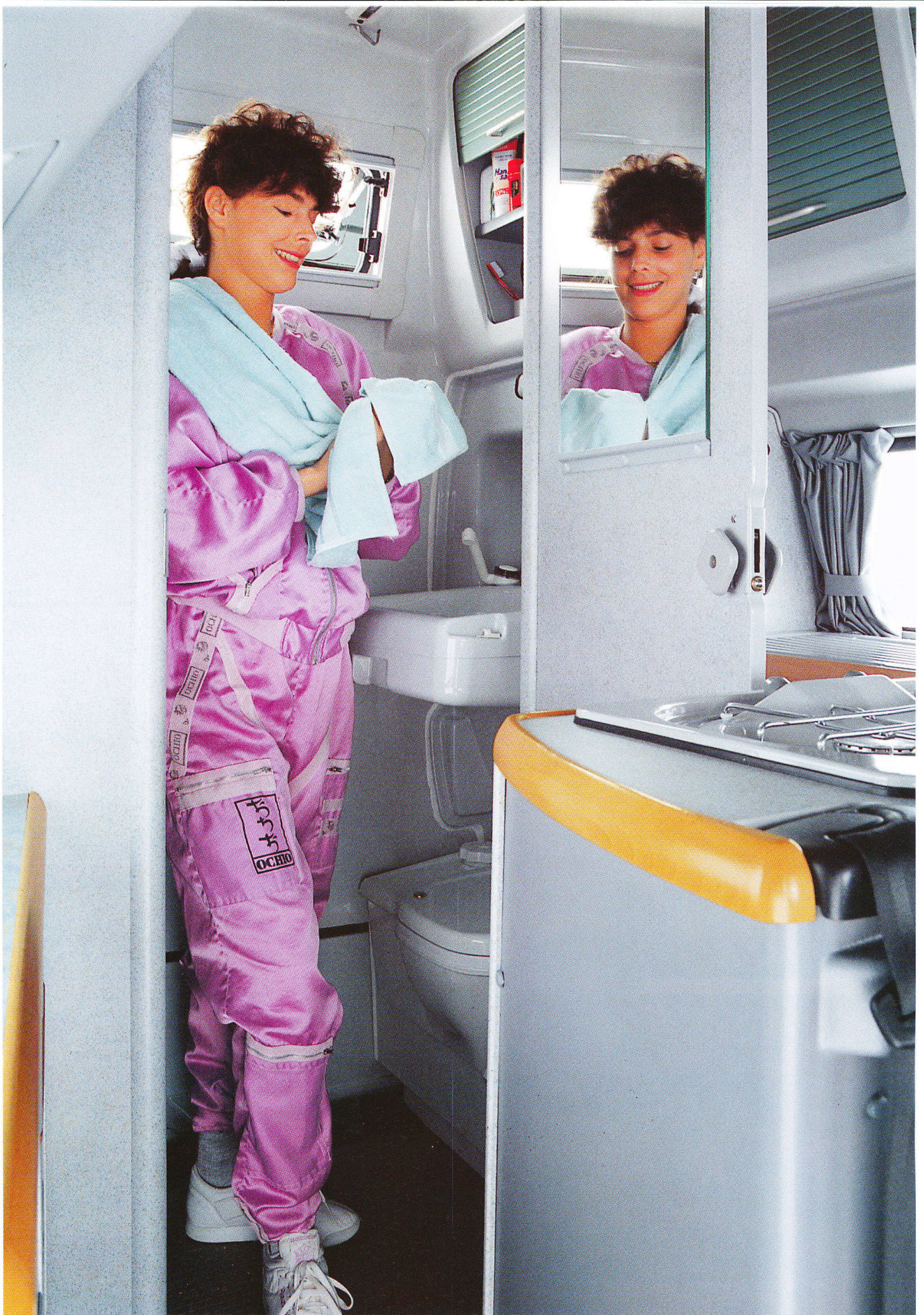
Abgeschlossener Sanitärraum mit Cassetten-Toilette und Klapp-Waschbecken
