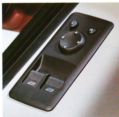
Bedienung für elektrische Fensterheber im Fahrerhaus und elektrische Außenspiegelausstellung (Sonderausstattungen)
