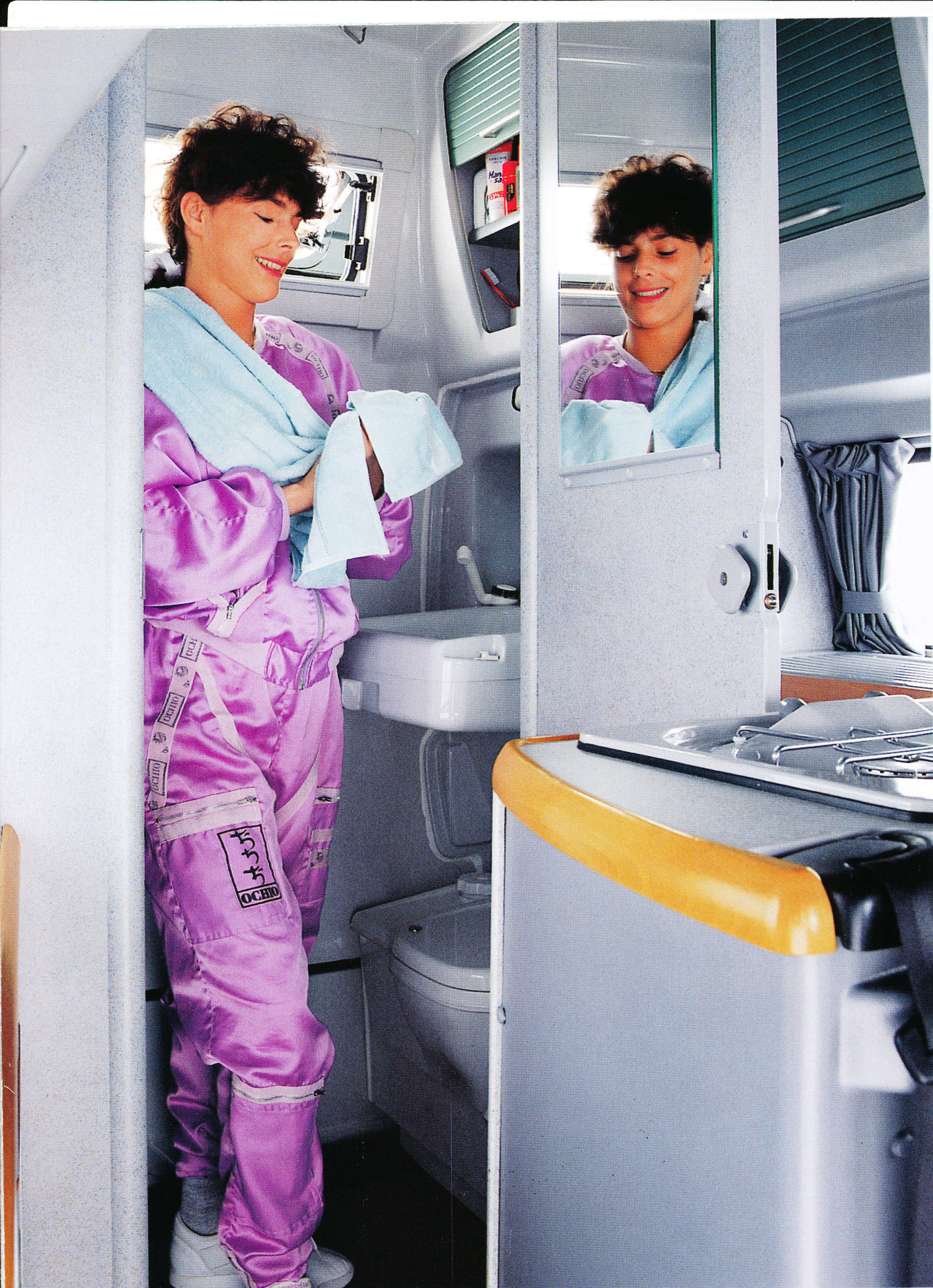
Abgeschlossener Sanitärraum mit Cassette-Toilette und Klapp-Waschbecken.
