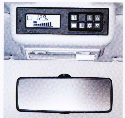
Im Blickfeld angeordnete Zentral-elektronik.
