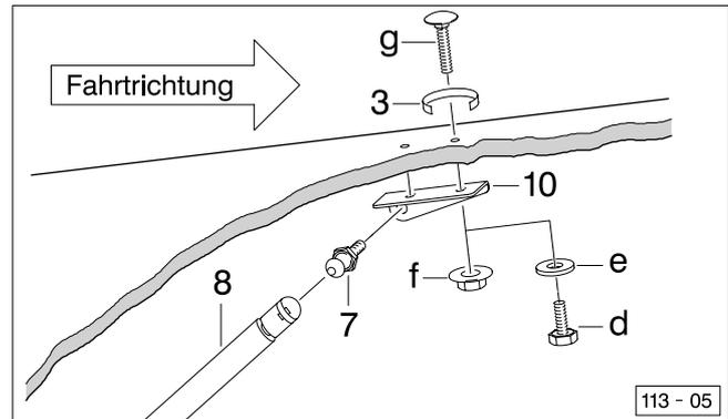
Abgebildet ist die Montagefolge links an der Dachschaale.
