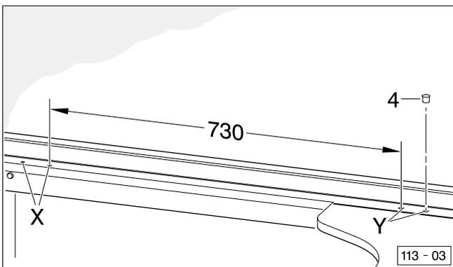
Bohrungen entgraten, Bohrspäne sorgfältig entfernen und Schnittkanten mit Korrosionsschutzmittel behandeln.
