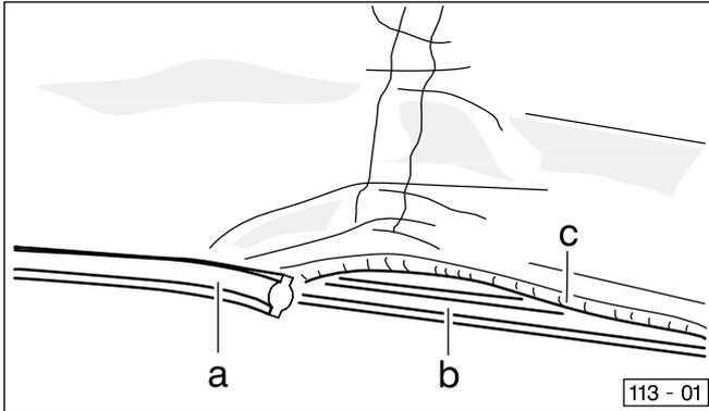
Füllkeder (a) und Einlegeschnur des Faltenbalges (c) aus der unteren Schiene (b) herausziehen.
