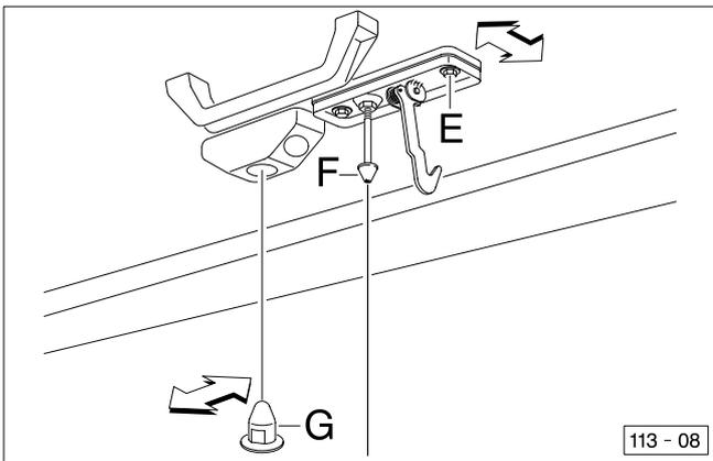
Nachdem die Einstellung des Aufsteldaches verändert wurde, muss überprüft werden, ob die Bettplatte noch in den Halter eingehängt werden kann.
