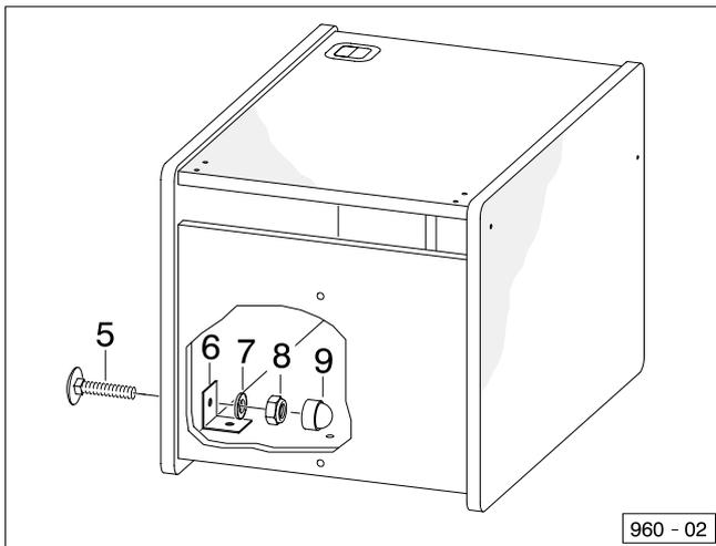
Die Flachrundschraube (5) von außen durch die unten am Staukasten befindliche Bohrung stecken, von innen den Winkel (6) gegenhalten und mit einer Scheibe (7) und der Sechskantmutter (8) verschrauben. Anschließend die Sechskantschutzkappe (9) auf die Sechskantmutter drücken.
